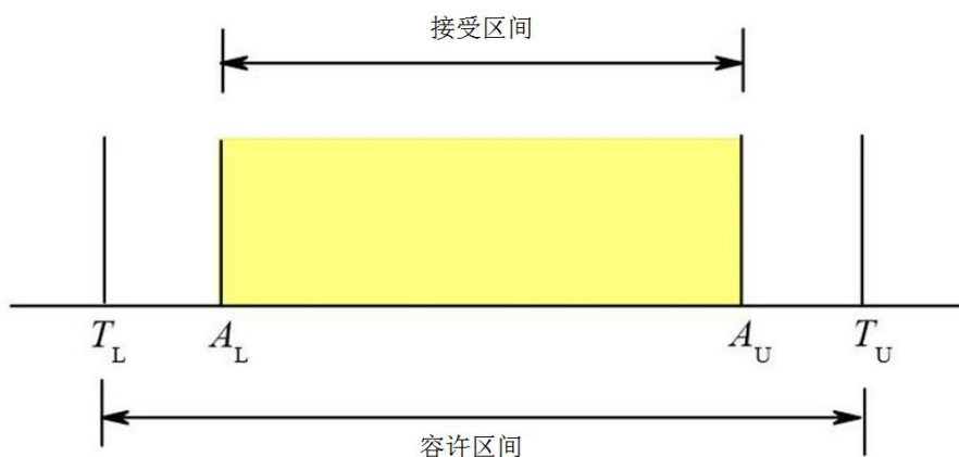
图 14 基于测得值的二元符合性判定，规定可测量属性（被测量）的真值需落在由容许区间 (T_L, T_U) 内，当属性测得值位于接受区间 (A_L, A_U) 内时判定为合格，反之为不合格。
